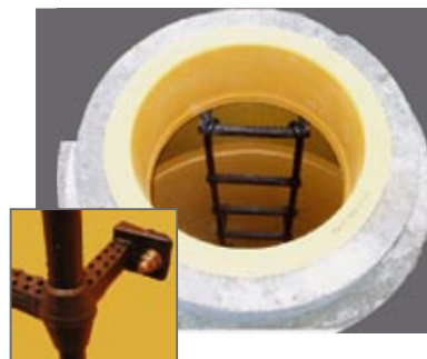
Konus zentrisch oder exzentrisch mit GU Teleskop und Lippendichtung
